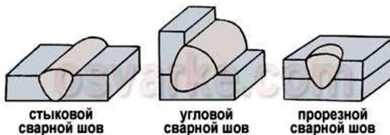
2. **Вопрос:** Спрогнозируйте последствия, которые могут возникнуть в процессе сборки сварной конструкции указанной на рисунке без применения сборочных приспособлений и соблюдения правил выполнения прихваток.
